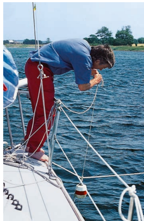
Handauflegeverfahren (links): Ob der Anker gefasst hat oder über den Grund rutscht, lässt sich am sichersten mit der Hand erfühlen. Mitte: Grasgrund sollte man meiden. Dieser Baas-Anker hat zwar noch gefasst, aber nur mit den Spitzen seiner Flunken. Bei zunehmendem Wind würde das Schiff auf Drift gehen. Rechts: Ankergewichte können wirkungsvoll den Zugwinkel verbessern. Aber Vorsicht: Die dünne Einholleine vertörnt sich leicht mit der Trosse
