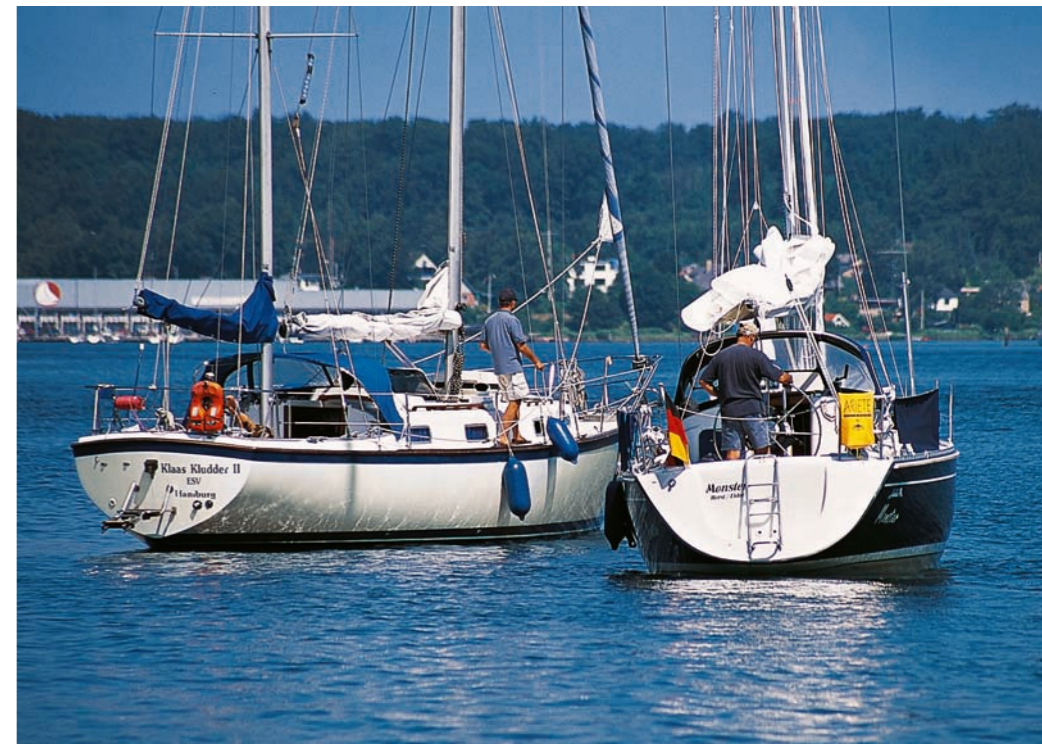
Längsseite gehen vor Anker ist nur in konstant ruhiger Wetterlage zu empfehlen. Im Starkwind auf Drift vertörnt sich das Grundgeschirr der Yachten leicht miteinander
