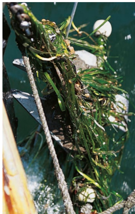
Handauflegeverfahren (links): Ob der Anker gefasst hat oder über den Grund rutscht, lässt sich am sichersten mit der Hand erfühlen. Mitte: Grasgrund sollte man meiden. Dieser Baas-Anker hat zwar noch gefasst, aber nur mit den Spitzen seiner Flunken. Bei zunehmendem Wind würde das Schiff auf Drift gehen. Rechts: Ankergewichte können wirkungsvoll den Zugwinkel verbessern. Aber Vorsicht: Die dünne Einholleine vertörnt sich leicht mit der Trosse
