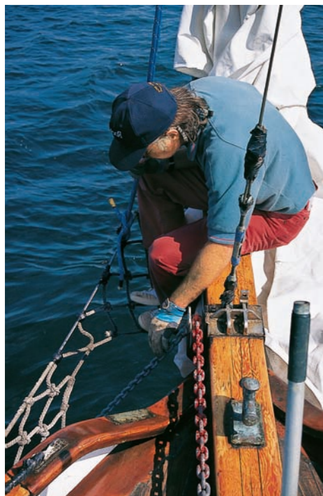
Handauflegeverfahren (links): Ob der Anker gefasst hat oder über den Grund rutscht, lässt sich am sichersten mit der Hand erfühlen. Mitte: Grasgrund sollte man meiden. Dieser Baas-Anker hat zwar noch gefasst, aber nur mit den Spitzen seiner Flunken. Bei zunehmendem Wind würde das Schiff auf Drift gehen. Rechts: Ankergewichte können wirkungsvoll den Zugwinkel verbessern. Aber Vorsicht: Die dünne Einholleine vertörnt sich leicht mit der Trosse
