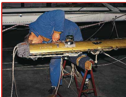
Die Beschläge des Mastes und Baums müssen besonders sorgfältig auf Korrosion und Verschleiß geprüft werden
