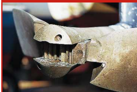
Mechanik der Faltpropeller prüfen: Auf älteren Schiffen ist sie häufig abgenutzt, Reparaturen sind teuer
