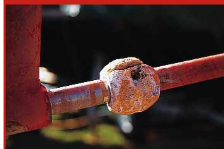
Zeigen Zinkanoden deutliche Korrosion, sind sie richtig angeschlossen und schützen Welle und Schraube
