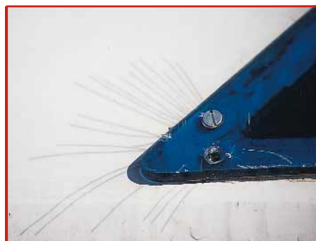
Stressrisse an spitz zulaufenden Fenstern sind auf älteren Schiffen häufig und sollten behoben werden
