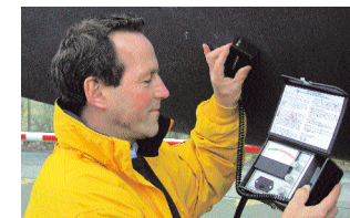
Im roten Bereich: Peter Wrede misst die Feuchtigkeit in einem Bootsrumpf
